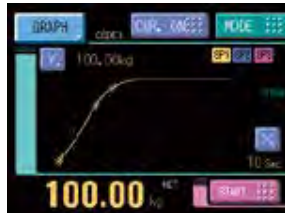
重量值的变化实时的通过波形显示
