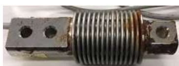
起歪体の腐食(もらい錆)
