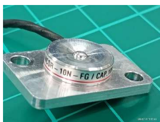
起歪体の凹み、変形
